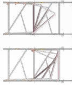
Debido a su diseño específico, MDS K se monta y desmonta bajo la protección de una barandilla circundante.
