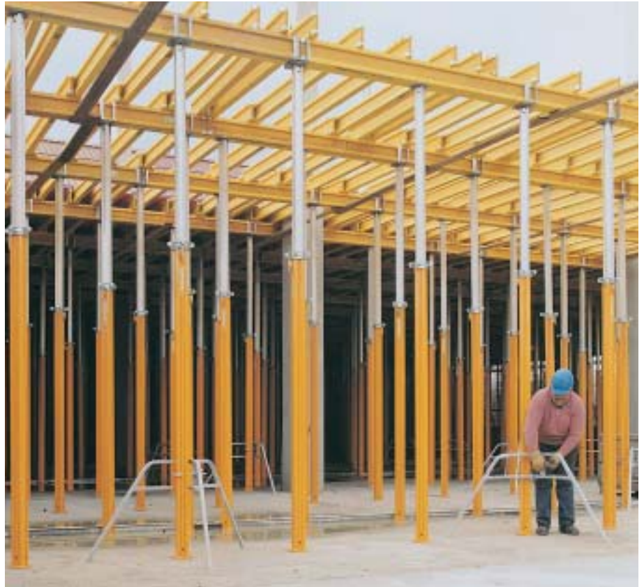
El trípode universal puede colocarse en los puntales para losas de \varnothing 48 hasta \square 120 mm.
