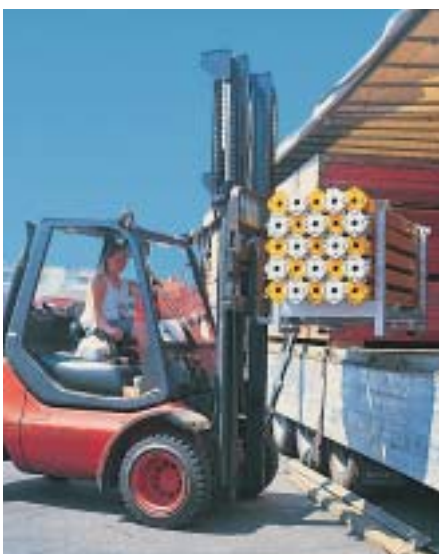
Los pallets con perfiles de apilado se adaptan a las medidas del espacio de carga de los camiones.
