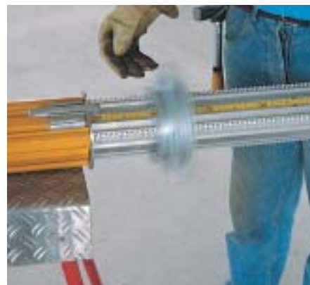
36 mm de carrera de ajuste con un sólo giro (3 veces más que los puntales convencionales para losas).
