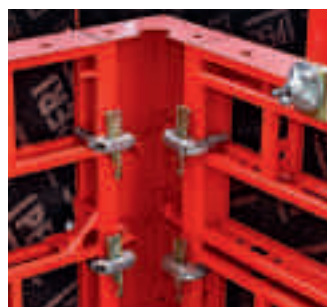
En la esquina interior y en el encuentro de módulos normal, se necesitan 2 cerrojos DRS con unidades de 2,50 m de alto.
